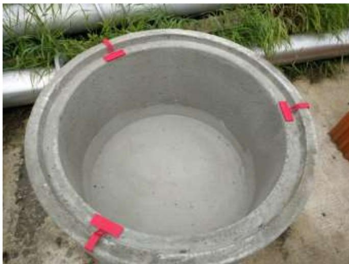
Abbildung 1: Schachtring mit eingelegten ABBIS (Schweighöfer, 2016)
